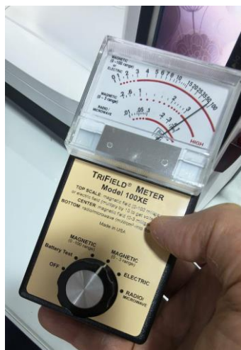
Figura 3. Teste de funcionamento do aparelho Trifield EMF Meter (modelo 100XE) posicionado próximo a um equipamento fora do laboratório. Leitura de campo magnético de 500 miligauss (valor detectado multiplicado por 10), validando a sensibilidade do instrumento
