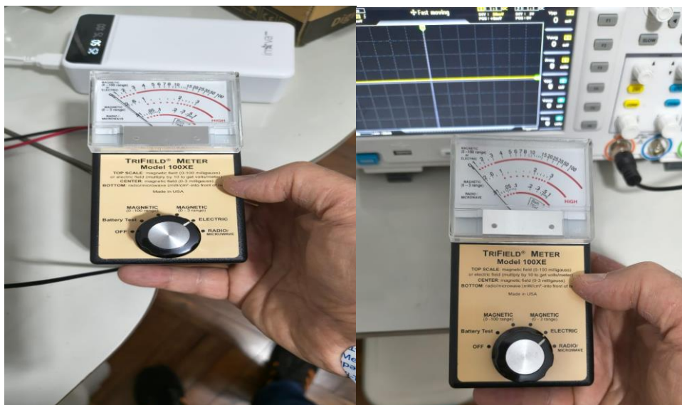
Figuras 1 (à esquerda). Medição de campo eletromagnético próximo ao powerbank utilizado no experimento. Nenhum campo detectado, indicando ausência de interferência eletromagnética
